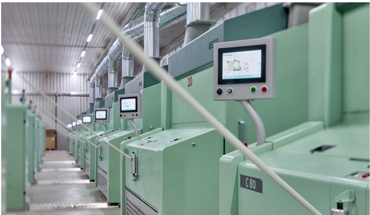
Ein Kunde verwendete für sein Rotorgarn eine Mischung aus 90% recycelter Baumwolle. Für solche Anwendungen ist die Karde C 80 besonders geeignet.
