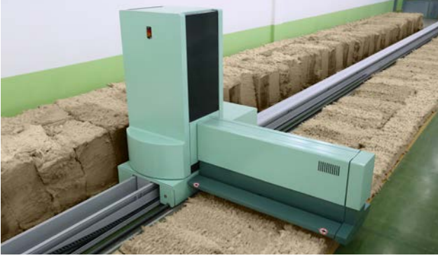
UNIfloc A 12'yle açma işlemi ideal elyaf tutamları sağlar
