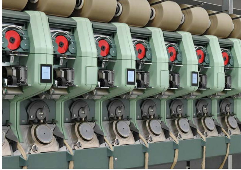
Standart ve fantezi iplikler bir open end iplik makinasında ekonomik olarak üretilebilir.
