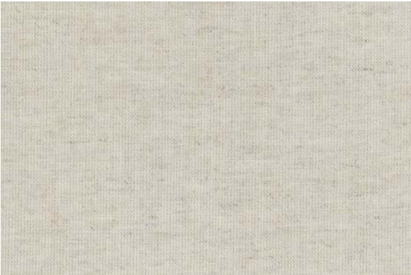
Kaplama kumaşı çözgüsü: Nm 28/2 pamuk iplik, ring iplik atkı: Nm 12 keten iplik, open end
