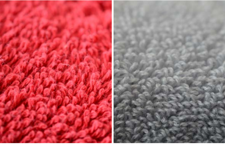
Şek. 3 Com4®jet iplikten üretilen Rieter havlu (sağda), yüksek kaliteli havlu ile karşılaştırıldığında görsel açıdan çok iyi bir performans sergilemektedir.
