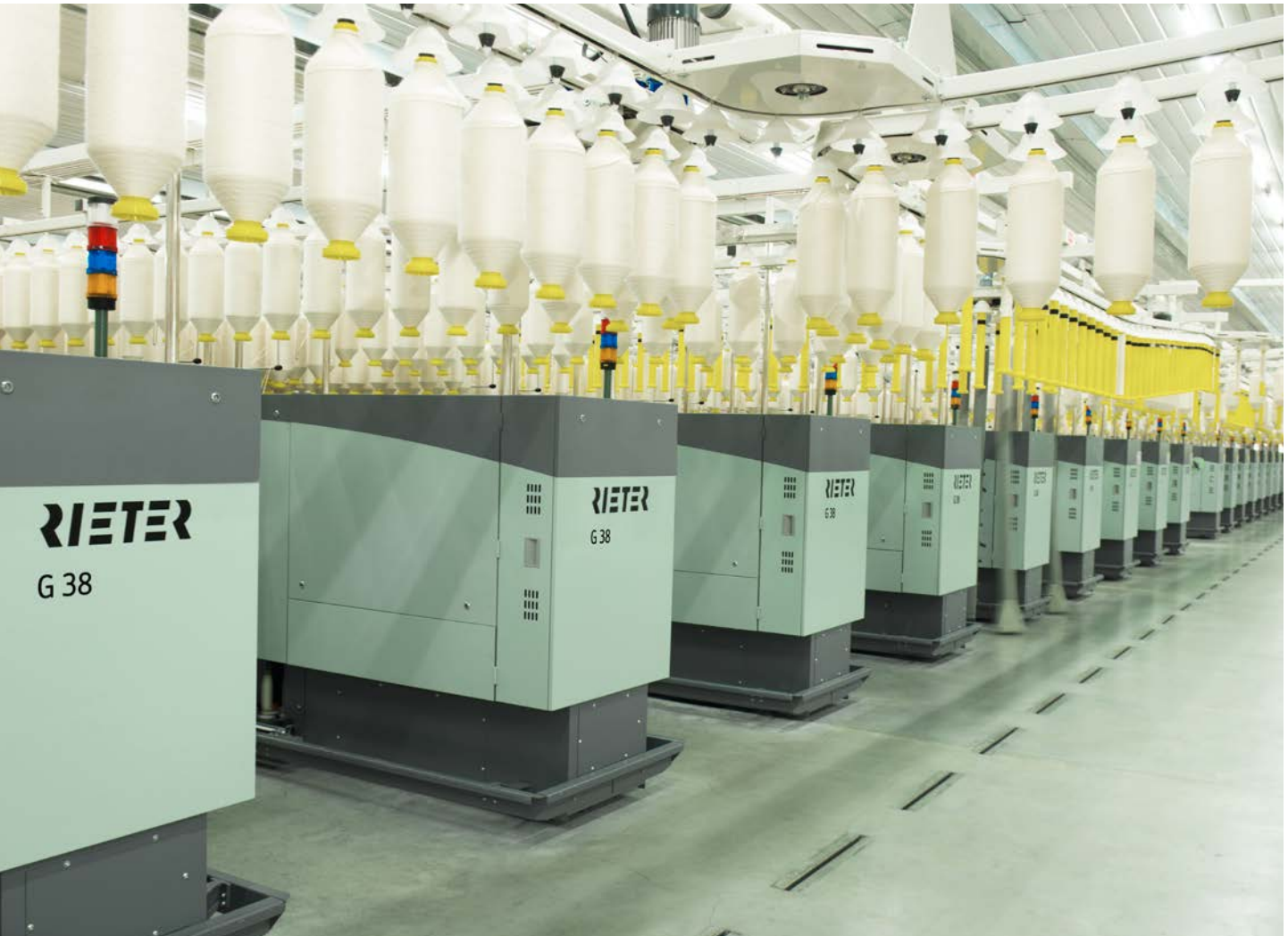
Şek. 1: Yeni ring iplik makinası G 38, dört yeni ring ve kompakt iplik makinasından biridir. En yüksek düzeyde otomasyon, mükemmel performans ve eksiksiz esneklik sunar.
