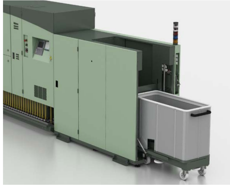
Şek. 7: Yeni masura yükleyici ROBOLoad "wild loading" boş masuraları otomatik olarak düzenleyerek gereken iş miktarını büyük ölçüde azaltır.
