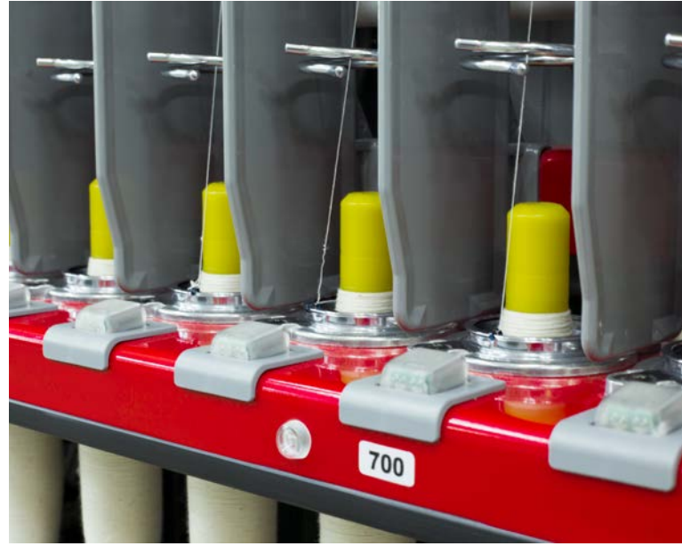
Şek. 2: Bireysel iğ izlemenin (ISM) en üst versiyonu, G 38 ve K 48 modellerine entegre edilmiştir. Bu, personel gereksinimlerini azaltır.
