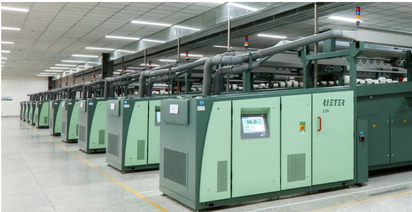
Una hilandería de Rieter con máquinas de hilar a aire J 26 produce hilos de algodón exclusivos de una manera extremadamente económica.
