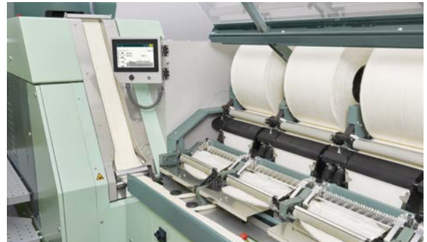
La nueva peinadora E 90 produce cinta de carda de la más alta calidad gracias a la tecnología integrada de manual SB-D 50.
