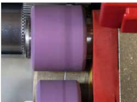
图 9: 升级版倚丽辊的胶辊可重复使用
