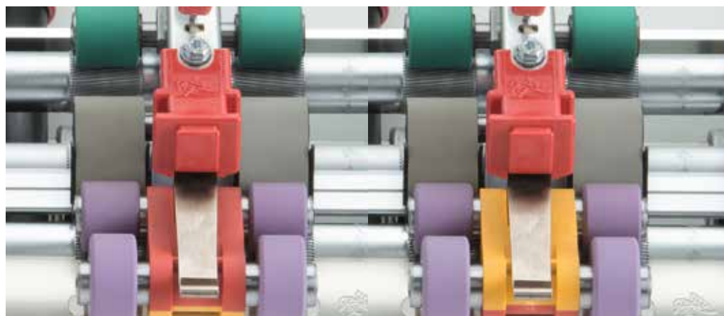
图 6: 对同一纱锭上的升级版倚丽辊进行上下翻转使用, 从红边向上一侧转至到黄边向上一侧
