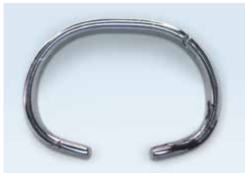
图1: 钢丝圈纱线通道的磨损
