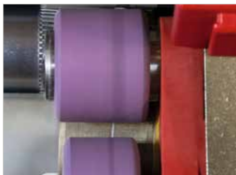
图8: 升级版倚丽辊的胶辊可重复使用
