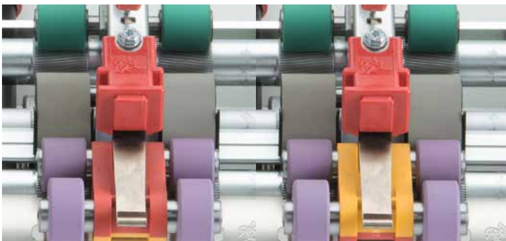
图5: 对同一纱锭上的升级版倚丽辊进行上下翻转使用, 从红边向上一侧转至黄边向上一侧
