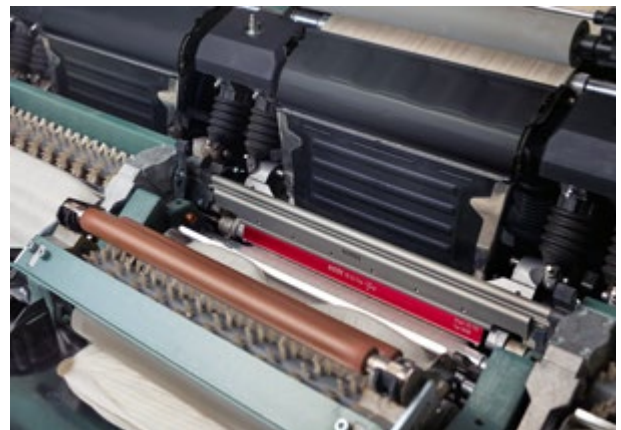
图6：精梳机E 90可确保轻柔、可控地处理纤维，进而实现更高的原料利用率。
