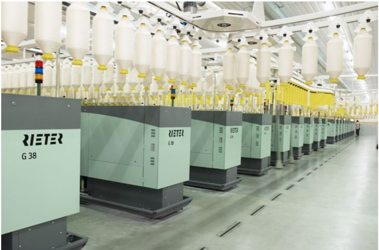
图11：环锭细纱机G 38采用了双侧吸风和高能效部件，能耗极低。
