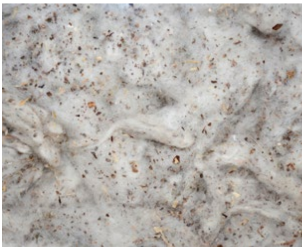
图5：使用废棉或高短纤维含量原料纺纱时，转杯纺短流程是理想的解决方案。
