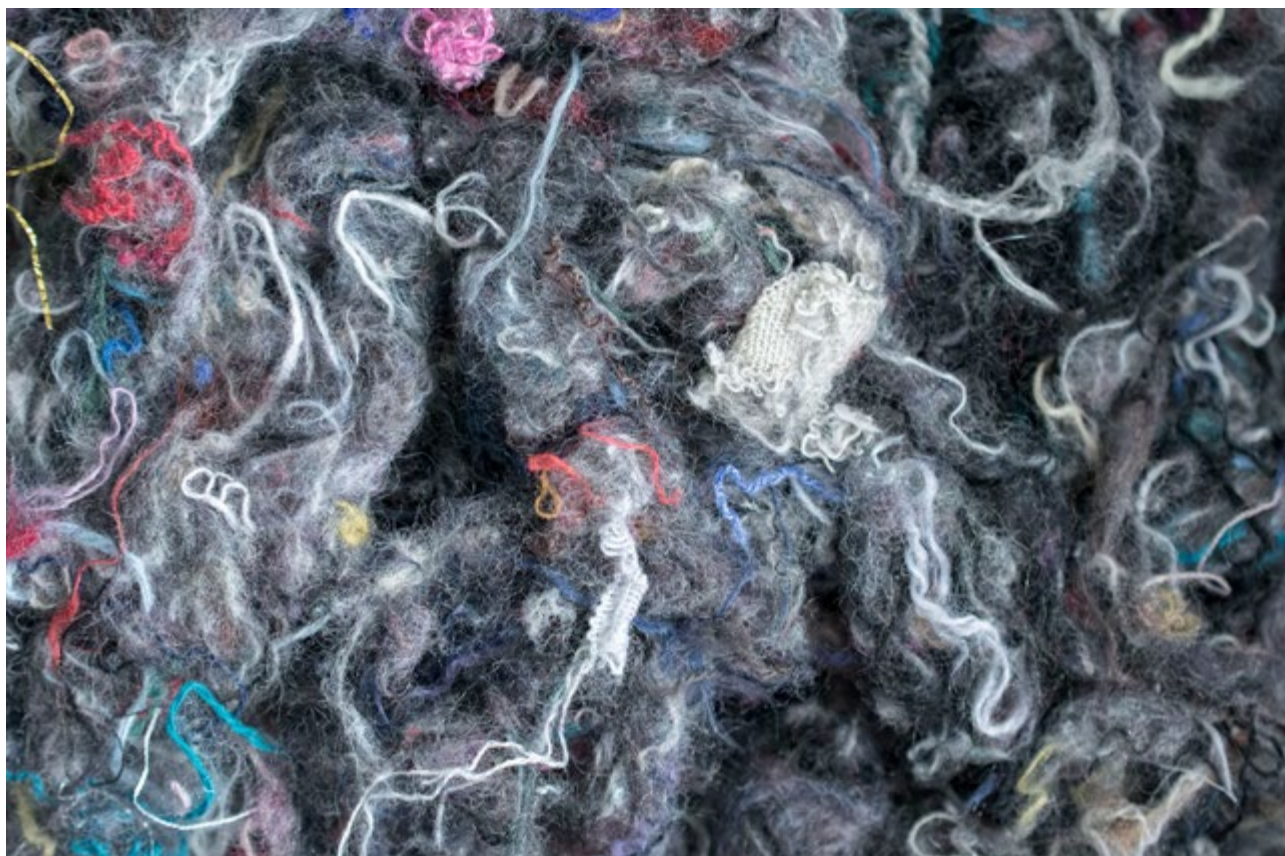
图2：立达纺纱系统提供多种可使用再生纤维生产环锭纱和转杯纱的解决方案。
